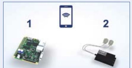
Envio de medições, dados de posição, relatórios de falhas e outros dados úteis do levantamento para a nuvem requer algum equipamento técnico. Ao lado de nosso controlador, que coleta todas as medições e dados, um gateway é necessário para converter as informações em valores compreensíveis da nuvem. Uma segunda função muito importante do gateway é conectar o controlador à internet com uma conexão segura.
