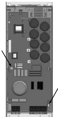
Figura 3.15: Classe de proteção EMC, MI5
